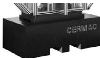
Plinto in Calcestruzzo
