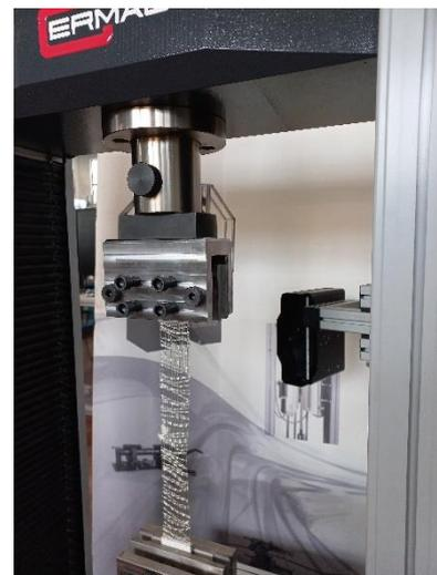
**Set-up di prova per esecuzione prove su FRP e FRCM con utilizzo di video estensimetro per misurare le deformazioni**
