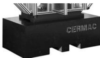
Plinto in Calcestruzzo
